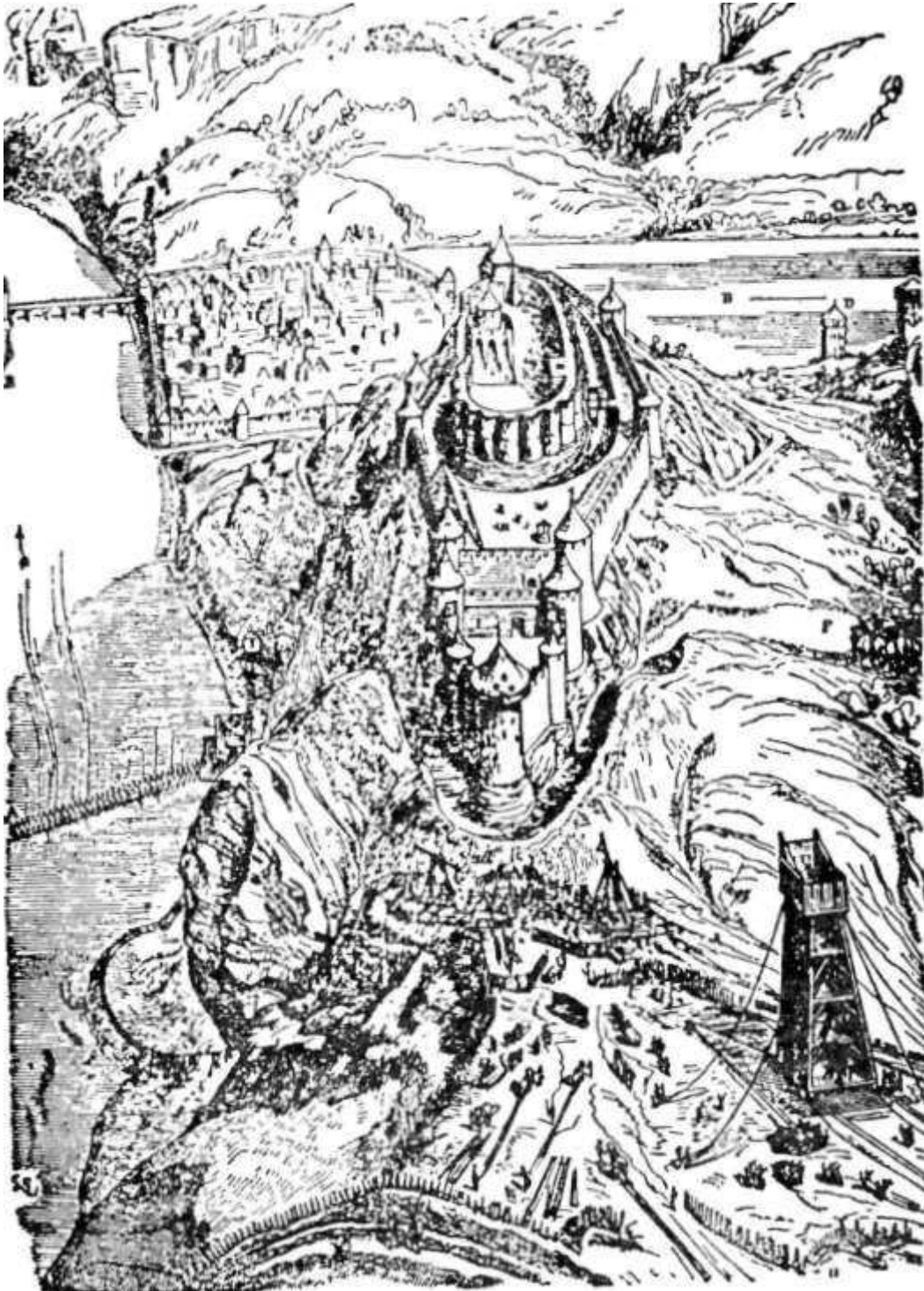
Chateau-Guillard, la fortaleza de Ricardo Corazón de León, en la orilla oriental del Sena, dominando la ciudad de Andelys. Un recinto elíptico, rodeado de un foso, envuelve el torreón. Obsérvese la imponente construcción externa, flanqueada por torres cilíndricas que avanzan como proa de un navío hacia el istmo que une la roca escarpada con la planicie.
